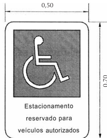
Fig. 88: Sinalização vertical em espaço interno
