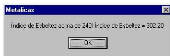
Figura 6. Tela indicando esbeltez excessiva.
