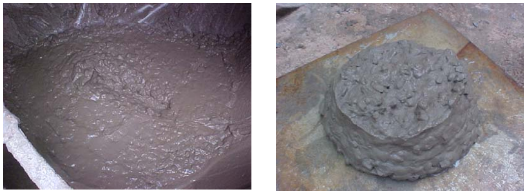
Figura 1 – Concreto com teor de argamassa de 57%.
