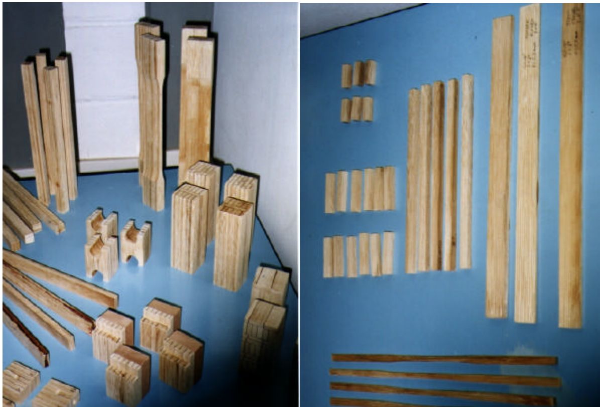
Figura 1- Amostras de bambu para ensaio de resistência mecânica
