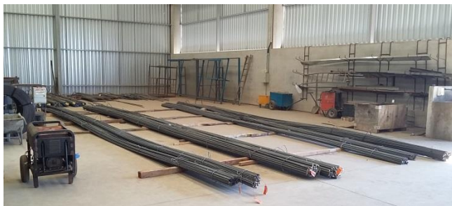
Figura 2.30 – Barras de armadura passiva em forma de segmentos retos e bobinas. (Fonte: Marka Soluções Pré-fabricadas, Fotografias do Autor)
