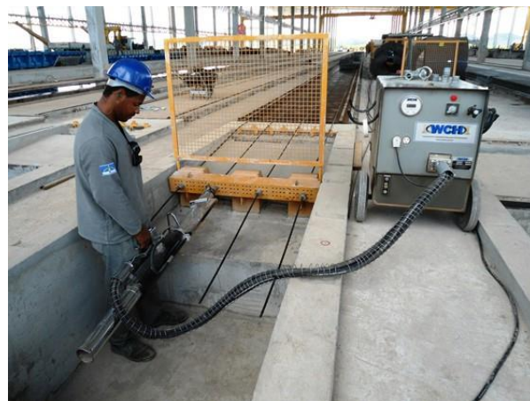
Figura 1.31 – Operação de estiramento de fio e cordoalha na ancoragem ativa de pistas de protensão. (Fonte: Weiler-C.Holzberger Ind. Ltda, http://wch.com.br )
