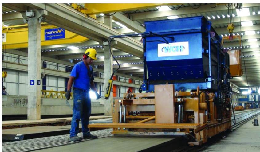
Figura 1.28 – Equipamento de moldagem de laje alveolar em pista de protensão. (Fonte: MARKA Soluções Pré-fabricadas, http://www.marka.ind.br )
