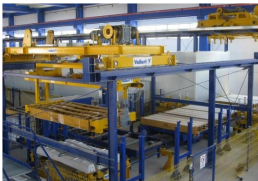
e) desmoldagem das peças por meio do giro das fôrmas;
