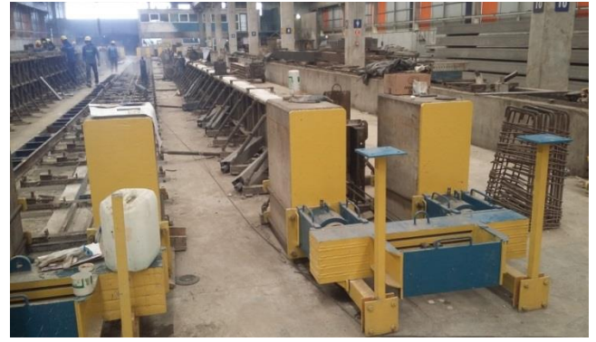
Figura 1.29 – Detalhes da ancoragem passiva (blocos de concreto e dispositivos metálicos) de pista de protensão para fabricação de vigas pré-moldadas, onde os fios ou cordoalhas são fixados na travessa metálica por meio de cunha e porta-cunha. (Fonte: Marka Soluções Pré-fabricadas, Fotografias do Autor)
