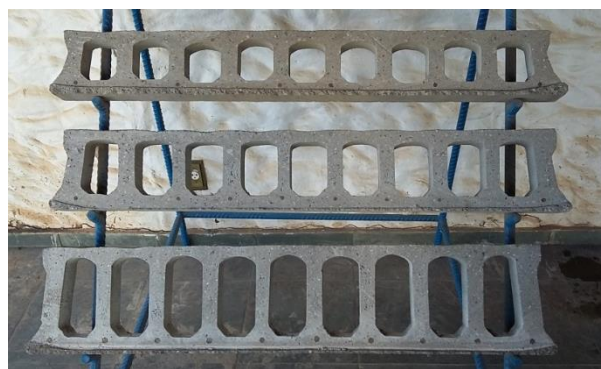
Figura 1.37 – Seções transversais de lajes alveolares, mostrando as cordoalhas de protensão.
