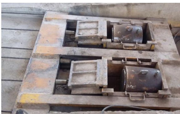
Figura 1.36 – Ancoragens passivas de pistas de protensão com cilindros hidráulicos utilizados para o relaxamento (soltura) dos fios da ancoragem em conjunto.
