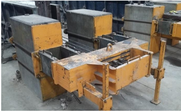
Figura 1.29 – Detalhes da ancoragem passiva (blocos de concreto e dispositivos metálicos) de pista de protensão para fabricação de vigas pré-moldadas, onde os fios ou cordoalhas são fixados na travessa metálica por meio de cunha e porta-cunha. (Fonte: Marka Soluções Pré-fabricadas, Fotografias do Autor)
