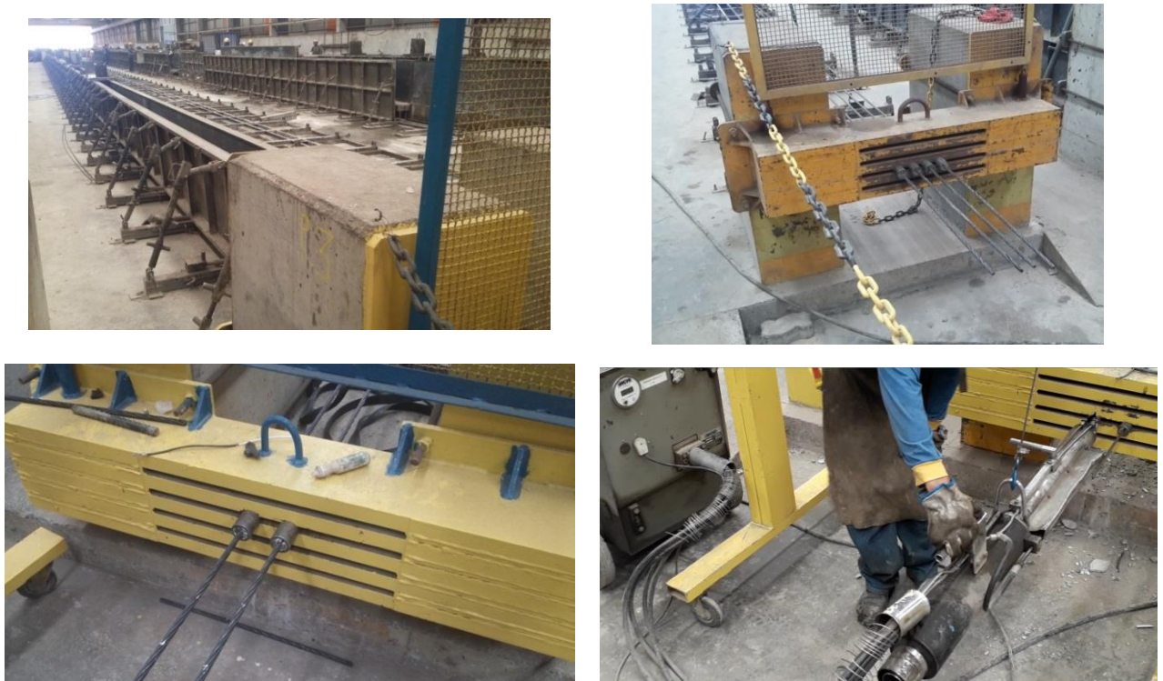
Figura 1.34 – Ancoragem ativa de pista de protensão para fabricação de vigas pré-fabricadas. (Fonte: Marka Soluções Pré-fabricadas, Fotografias do Autor)
