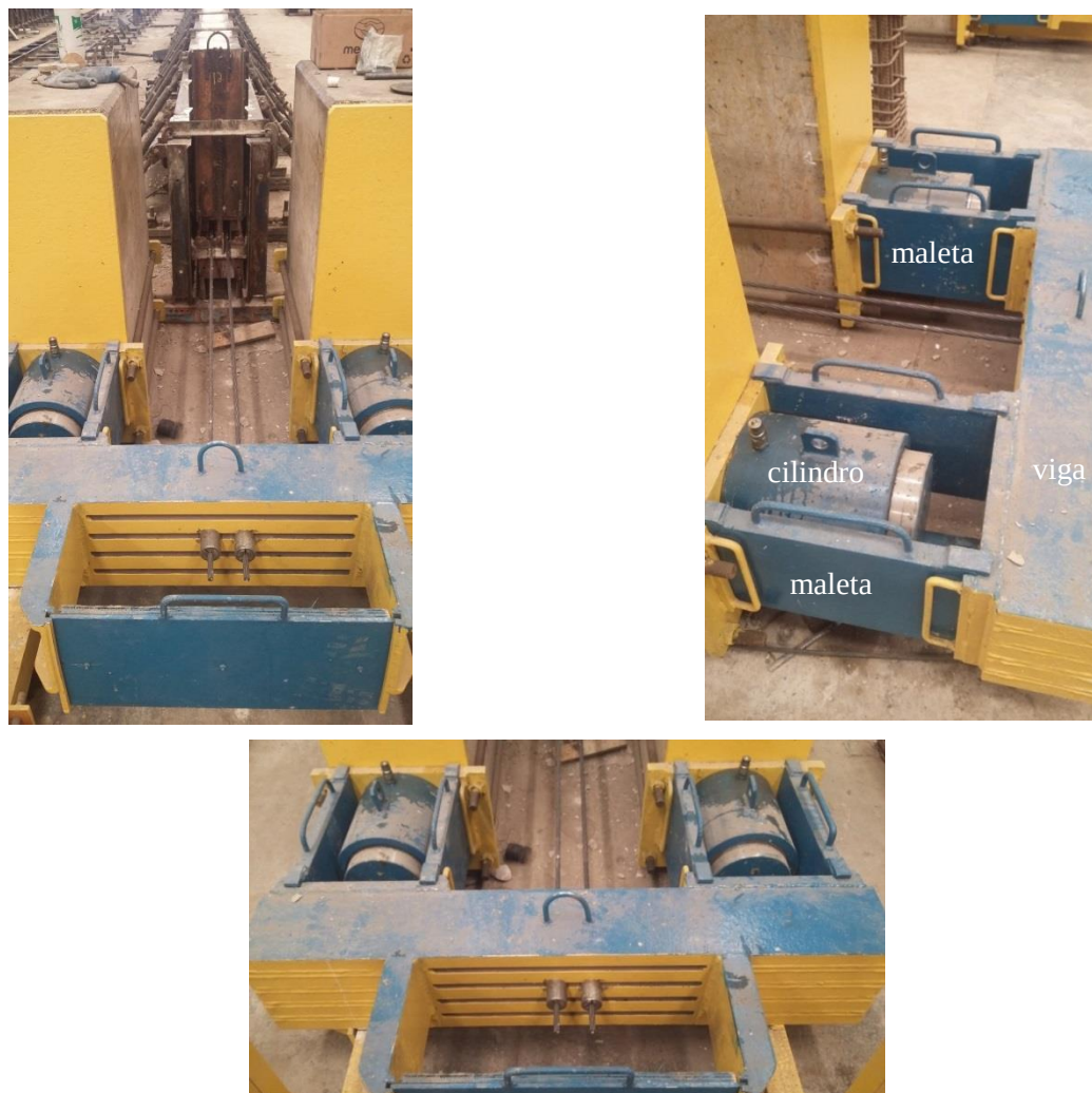
Figura 1.35 – Ancoragem passiva em pista de protensão para fabricação de vigas pré-fabricadas. (Fonte: Marka Soluções Pré-fabricadas, Fotografias do Autor)
