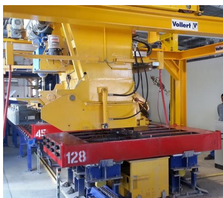
c) lançamento do concreto nas fôrmas;
