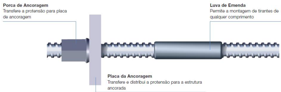
Figura 2.22 – Barra de aço Dywidag, com dispositivos de ancoragem. (Fonte: Catálogo Dywidag [6] )
