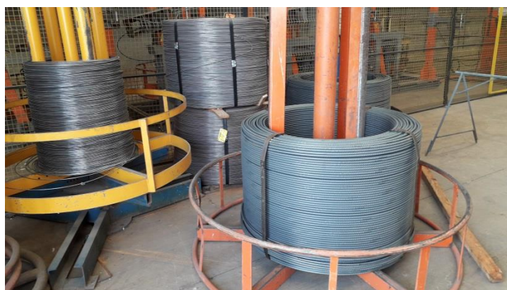
Figura 2.31 – Armazenamento de barras e fios na forma de rolos (bobinas). (Fonte: Marka Soluções Pré-fabricadas, Fotografias do Autor)
