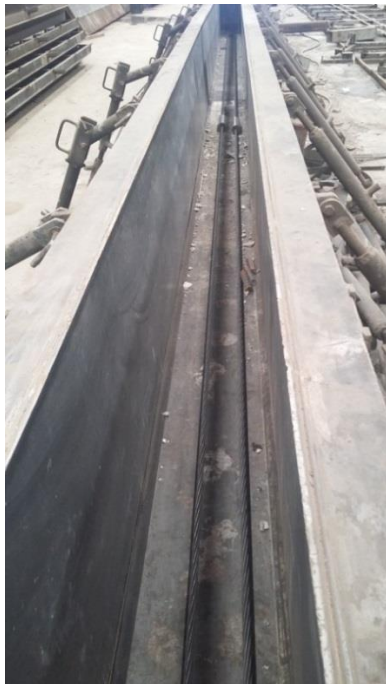
Figura 1.30 – Pista de protensão para fabricação de vigas. (Fonte: Marka Soluções Pré-fabricadas, Fotografias do Autor)
