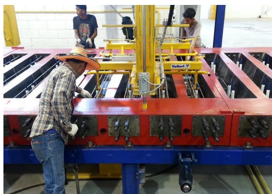
a) posicionamento e fixação dos fios de protensão no interior da fôrma metálica. A fixação neste caso é feita por meio de porca rosqueada no fio;
