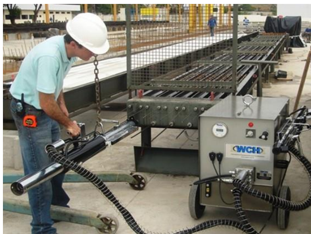
Figura 1.33 – Operação de estiramento de fio na ancoragem ativa de estrutura metálica de protensão. (Fonte: Weiler-C.Holzberger Ind. Ltda, http://wch.com.br )
