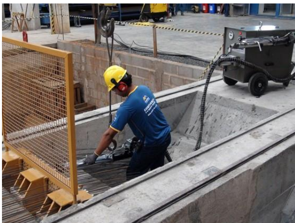
Figura 1.31 – Operação de estiramento de fio e cordoalha na ancoragem ativa de pistas de protensão. (Fonte: Weiler-C.Holzberger Ind. Ltda, http://wch.com.br )
