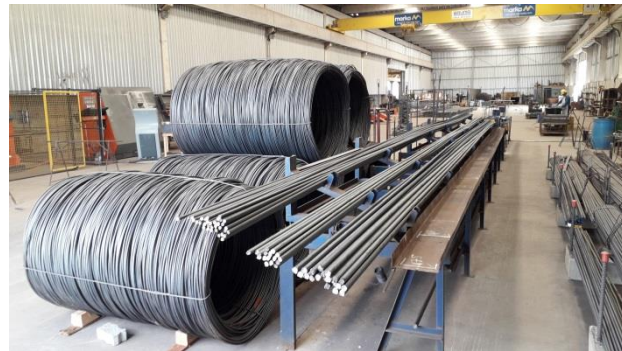
Figura 2.30 – Barras de armadura passiva em forma de segmentos retos e bobinas. (Fonte: Marka Soluções Pré-fabricadas, Fotografias do Autor)
