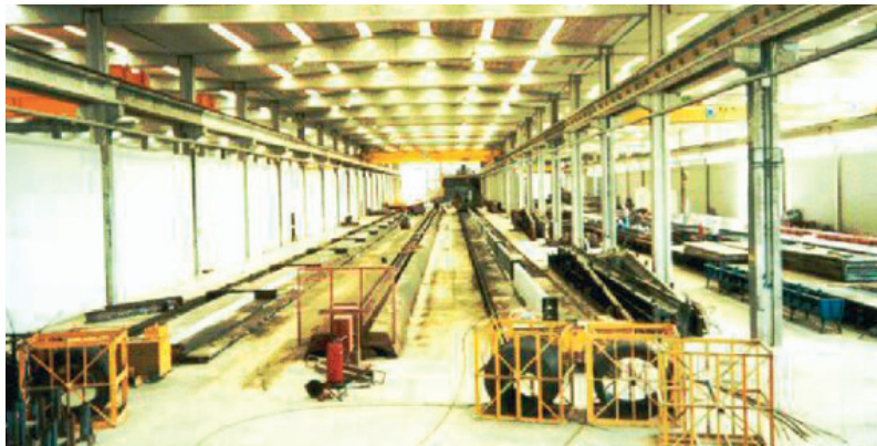
Pistas de protensão em fábrica de pré-fabricados protendidos
