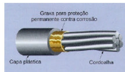
Cordoalha engraxada e plastificada
