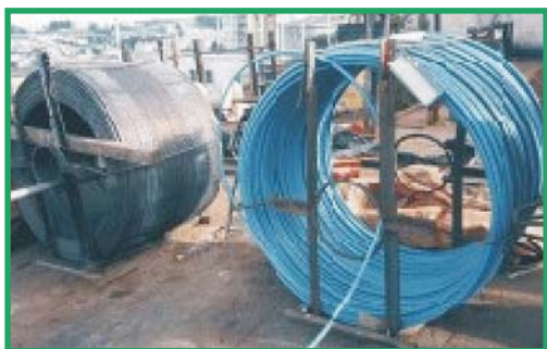
Foto 1: bobinas de aço de protensão
