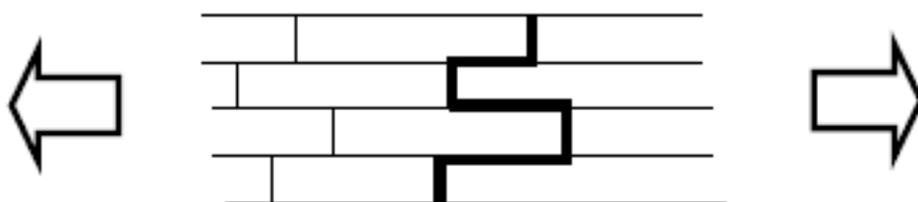
**Figura 1.3.13 – Tração nos blocos – devido a esforço horizontal**
