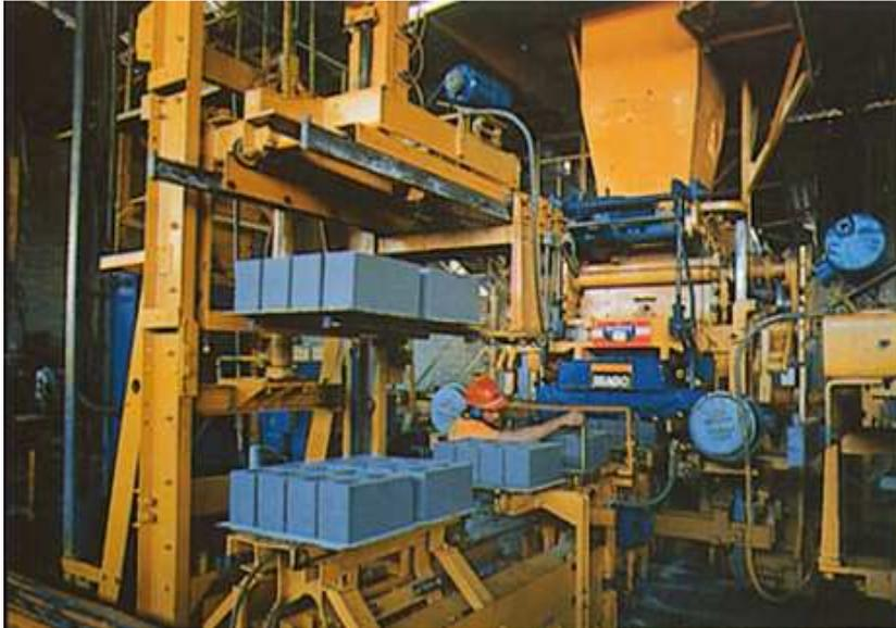
O bloco de concreto é um componente normalizado pela ABNT (NBR 6136), confeccionado por máquinas que lançam, prensam e vibram o concreto, em formas de aço.
