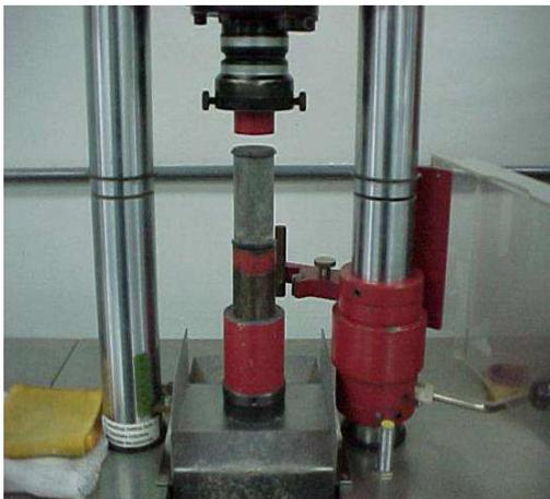
**Figura 1.3.7 – Ensaio da argamassa à compressão;**
