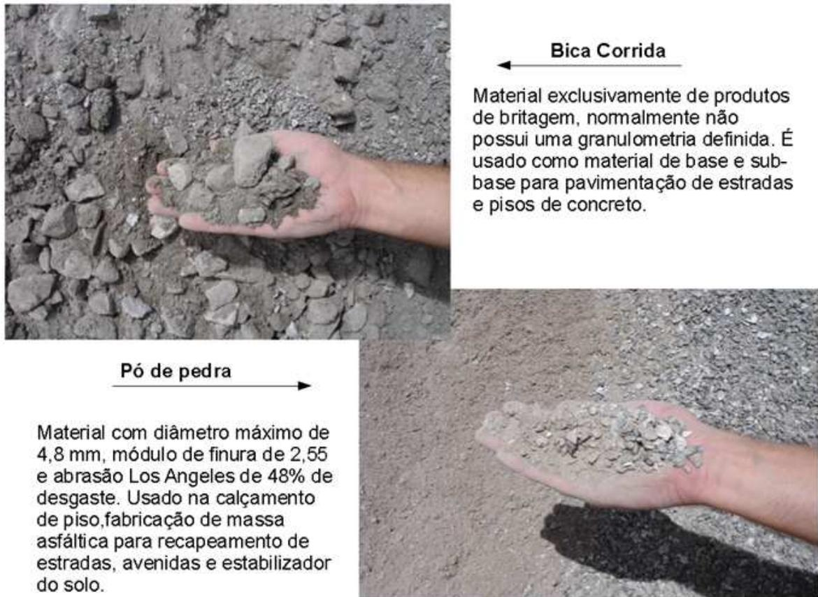
Figura 1.2.12 – Classificação de agregados – Bica corrida e pó de pedra
