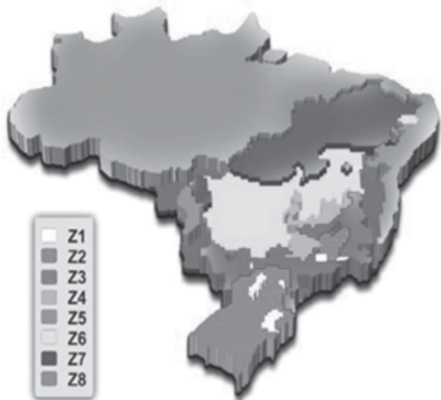
Figura 5 – Zoneamento bioclimático brasileiro (ABNT NBR 15220-3)
