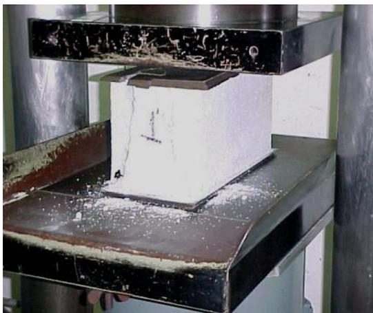
**Figura 4.3: Ensaio de resistência a compressão (ABCP)**
