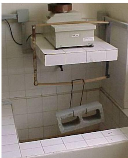
Figura 4.2: Ensaio de absorção (Parsekian, 2011)
