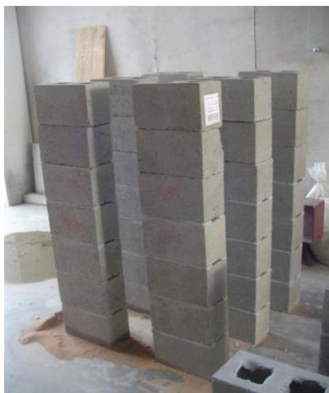
**Figura 4.6: Preparação dos blocos para ensaio. (Parsekian 2011)**
