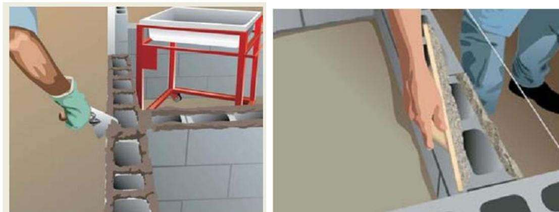
**Figura 4.13: Forma de aplicação da argamassa de assentamento sobre blocos (ABCP)**
