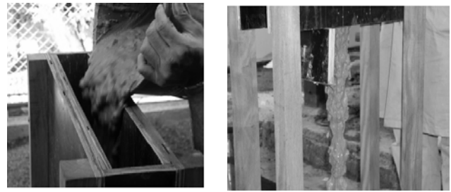
Figura 2. Execução do ensaio Funil-V.
