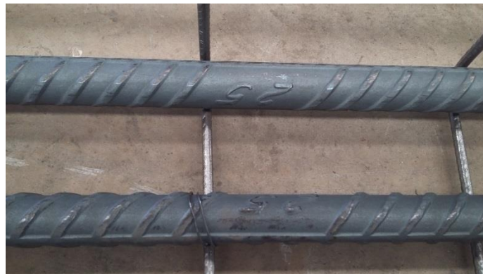
Figura 2.27 – Barra nervurada CA-50 \phi = 25 mm (Fonte: Marka Pré-Moldados - Fotografia do Autor).
