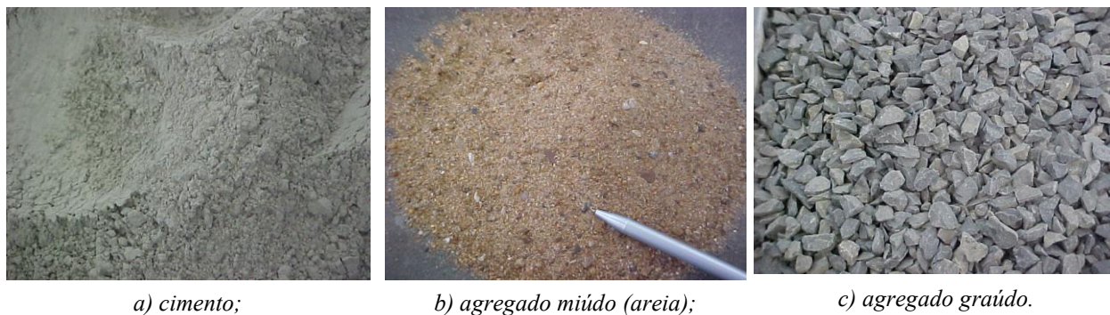
Figura 2.1 – Materiais básicos constituintes do concreto.
