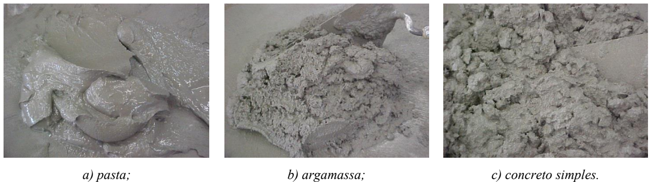
Figura 2.2 – Fases do concreto.
