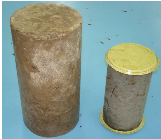
Figura 2.5 – Corpos de prova cilíndricos 15 x 30 cm e 10 x 20 cm para determinação da resistência à compressão de concretos (Fotografia de Obede B. Faria).
