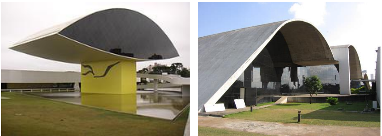
Figura 4.3 – Exemplos de estrutura com superfícies em casca.
