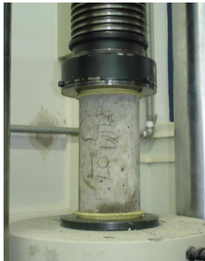
Figura 2.6 – Corpo de prova cilíndrico em ensaio em prensa hidráulica para determinação da resistência à compressão do concreto (Fotografia de Obede B. Faria).
