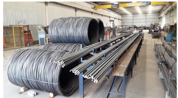
b) vergalhões em barras retas e em rolos (Fonte: Marka Pré-Moldados - Fotografia do Autor).
