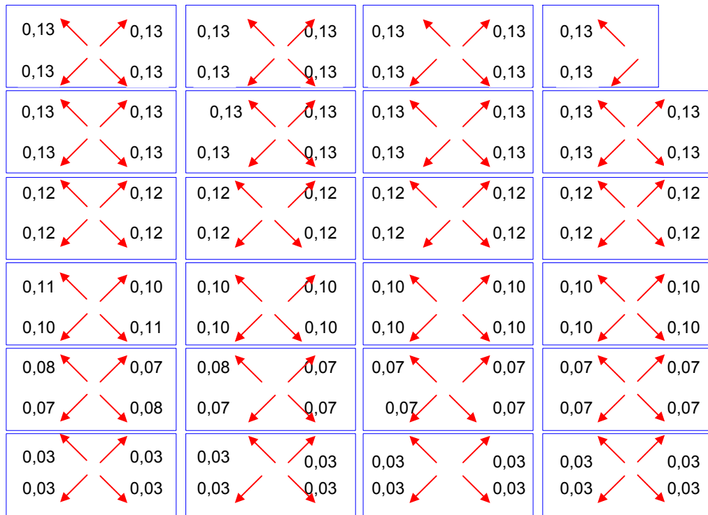
Figura 6 - Esforços de cisalhamento em kN: carregamento 1, pilares 600x600mm 2 , comprimento de pino de 200mm
