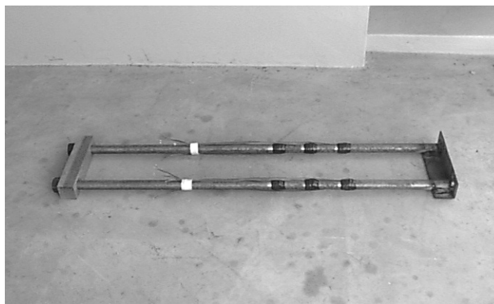
Figura 11 – Vista da instrumentação nos chumbadores utilizada para os Protótipos 3 e 4
