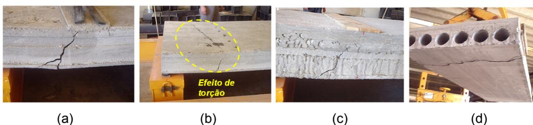
Figura 3 – Configuração de fissuração (a) e (b) unidades sem capa, (c) e (d) unidades com capa.
